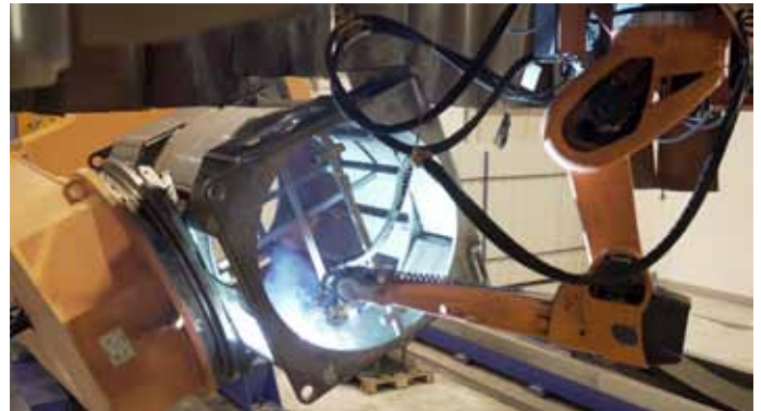
Bild 1: Kurze Schweißnähte schweißt der Roboter im Eindraht-, lange Schweißnähte im Tandemverfahren.
