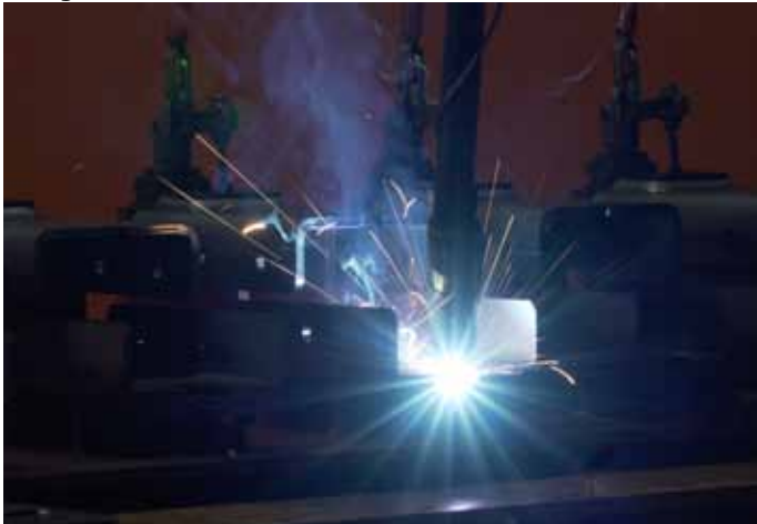
Bild 2: Früher hat ein MAP-Mitarbeiter 150 dieser Kleinteile in einer Schicht handgeschweißt, heute schafft der Schweißroboter in der Kompaktanlage 350 Teile pro Schicht.
