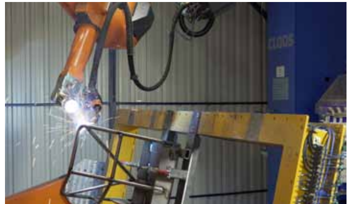
Bild 3: Die hohe Reichweite des siebenachsigen Roboters vereinfacht und beschleunigt das Schweißen der teils komplexen Werkstücke.
